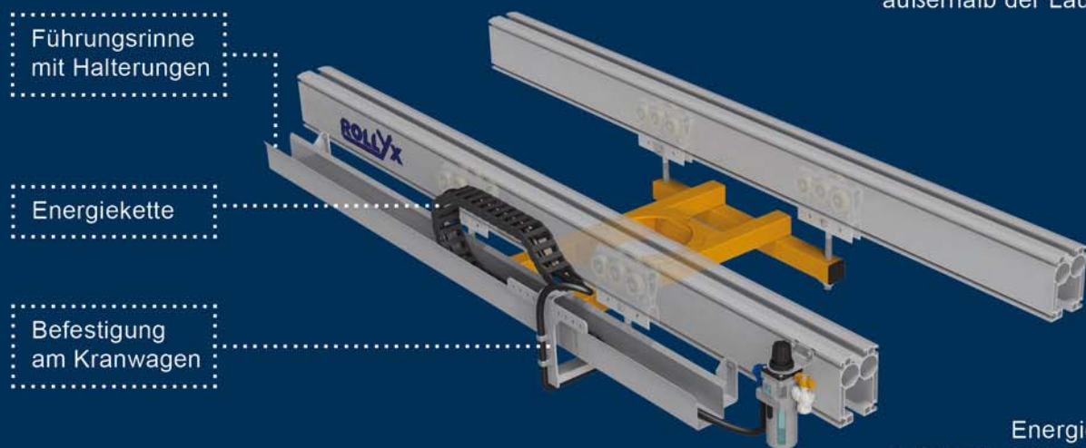
Energiezuführung in C-Schiene außerhalb der Laufbahn
