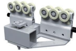
Mit der Aufbockung können die Brücken zwischen den X-Schienen platzsparend angehoben werden. Nutzbar bei niedrigen Räumen. Die Unterkanten von Bahn und Schiene befinden sich so auf gleichem Niveau. Alternativ kann die X-Schiene auch auf die Höhe der Oberkante der X-Schienenbahn angehoben werden um noch mehr Platz zu erreichen. Eine konstruktive Auslegung ist erforderlich. **Nutzbar bei niedrigen Räumen!**
